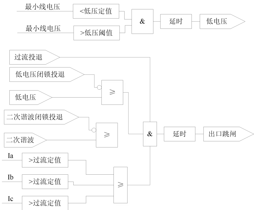
图 2.1 三段式过流保护逻辑
